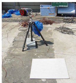
Fig.7 濾紙を用いた物質伝達率の測定
